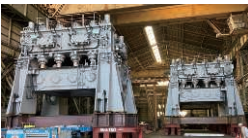
洋上風車建設時に使用する自己昇降式作業台船（SEP船）昇降装置
