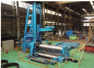
厚板の曲げ加工が可能な大型ベンディングロール
