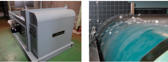
図9 非鉄金属選別機試作機(左: 試作機全体 右: 選別部)
