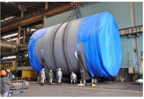
風車を支える基礎部位
