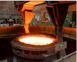
炉外精錬装置
