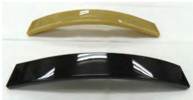
図. FRP板ばね試験品（上：GFRP, 下：CFRP）
