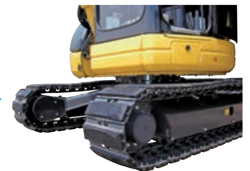
「イーグルパッド」 油圧ショベルの鉄履帯に装着し、舗装路面を傷めることを防ぐゴム製のパッド
