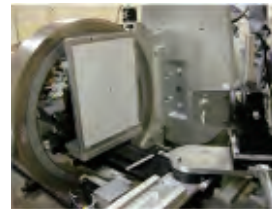
(a) 高エネルギー加速器研究機構の放射光施設で行ったcos \alpha 法の適用に関する実験で使用した装置の写真
