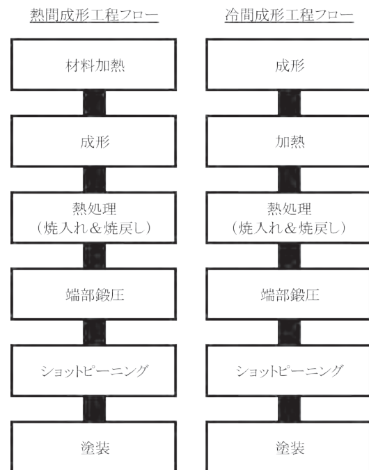
図1. スタビライザー製造工程フロー
